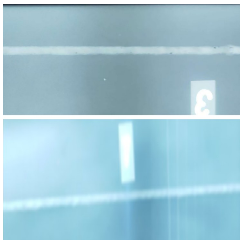
图2 国产手持激光焊机与IPG手持激光焊机X射线探伤照片局部放大
