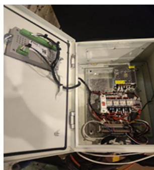
图5 松下焊接机械手信号接收、控制盒
